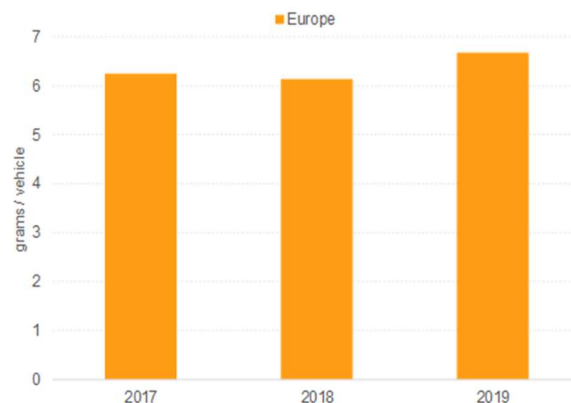
図 6: 自動車一台につき使用されている白金族金属量—2019年のユーロ 6d Temp 対応、RDE 導入による増加が新型コロナ関連の需要減を相殺
